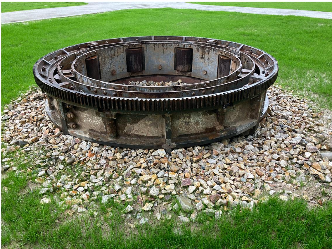
Cet anneau faisait partie de la base des grues qui étaient disposées sur les quais, on peut voir les roulements cylindriques qui permettaient la rotation de la grue.
