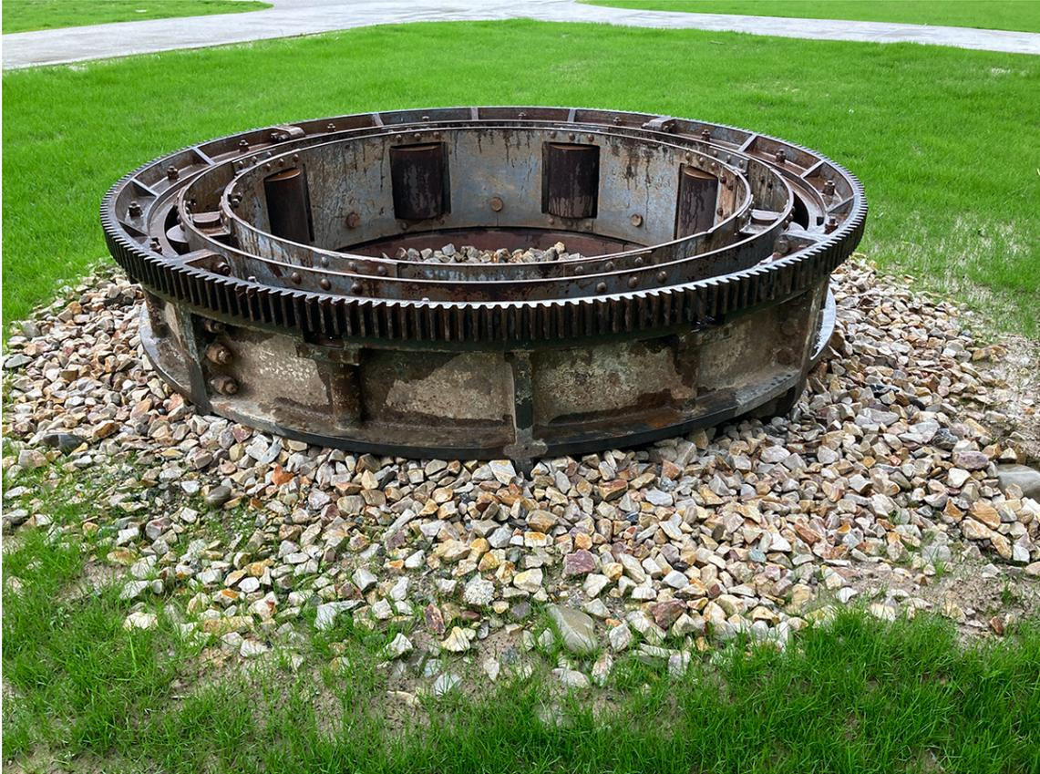
Este anillo formaba parte de la base de las grúas que estaban dispuestas en los muelles, se pueden apreciar los cojinetes cilíndricos que permitían la rotación de la grúa.
