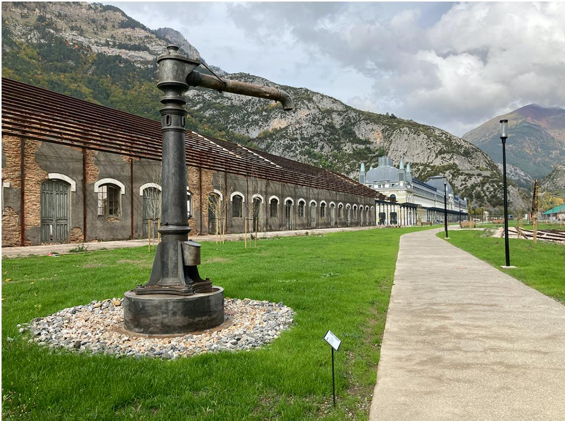
Les «aguadas » sont des éléments ferroviaires constitués d'une colonne creuse et fixe en un point, et d'un bras rotatif sur l'axe central de la colonne par lequel circulait l'eau alimentant les réservoirs des locomotives à vapeur stationnées à son côté.
