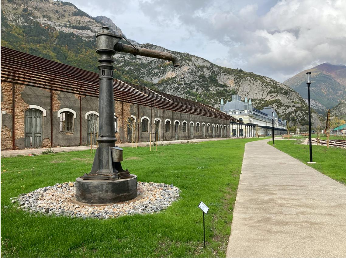
Las aguadas, son unos elementos ferroviarios consistentes en una columna hueca y fija en un punto, y un brazo giratorio sobre el eje central de la columna por el que circulaba y se proporcionaba agua a los depósitos de las locomotoras de vapor que se estacionaban a su costado.
